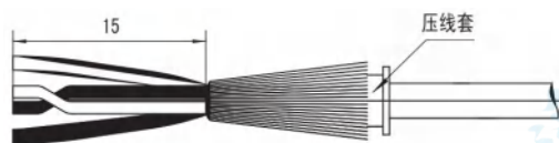
图2.4 梳理反折屏蔽层
