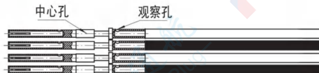
图2.7 压接中心接触件
