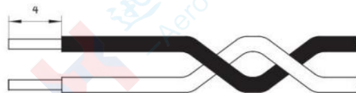
图1.6 剥去导线绝缘层
