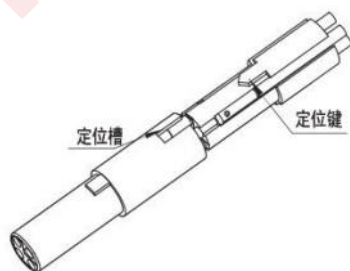
图2.10 压线绝缘子与插孔绝缘子相配合
